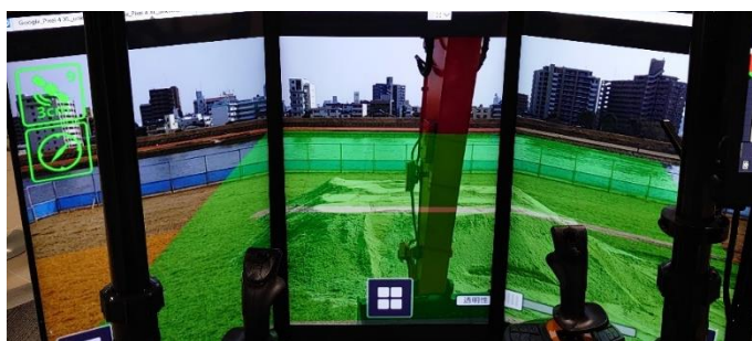
遠隔操縦モニターに表示されるAR映像(3次元設計データ)
