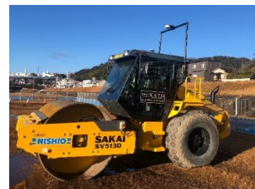
遠隔操縦ユニット搭載のブルドーザと土工用振動ローラ
