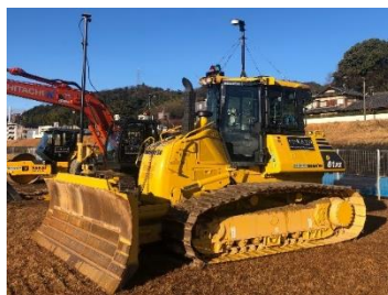
遠隔操縦ユニット搭載のブルドーザと土工用振動ローラ
