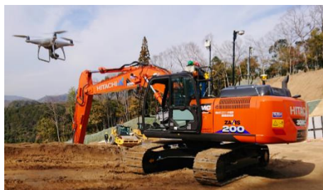
遠隔操縦されるICT 油圧ショベル ZX200X-6
