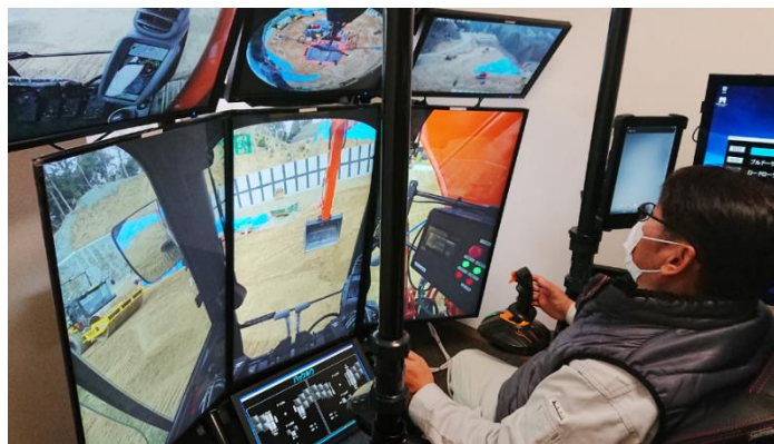
3 種類の建設機械を遠隔操縦
