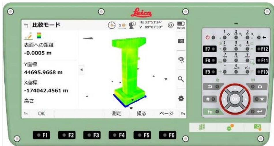
図 4-6-1 面的評価の例（清谷高架橋 P3 橋脚）
