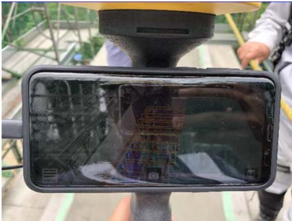
(配筋状況確認)
