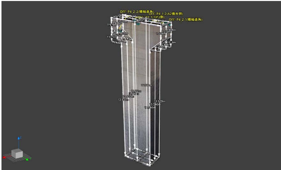
図 3-2-10 (1) 点群データ (上瀬野 IC OFF ランプ橋 P4 橋脚、躯体全体)
