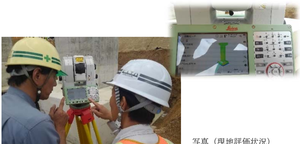
図 4-6-1 面的評価の例（清谷高架橋 P3 橋脚）
