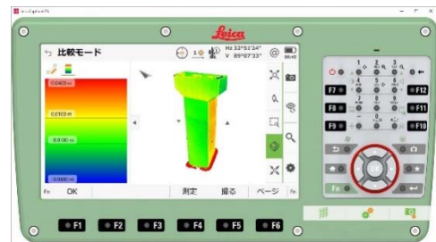
参考図 1-4 OFF ランプ橋 P5 表面評価
