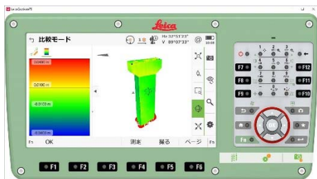
参考図 1-3 OFF ランプ橋 P4 表面評価
